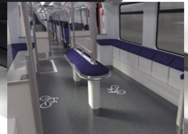
Auch Radfahrer sind bald komfortabler unterwegs. Die Fahrradabteile sind in der Mitte mit Inseln ausgestattet, an denen man sich anlehnen oder festhalten kann. Das Fahrradabteil ist von beiden Seiten erreichbar, das erleichtert den Zugang.
